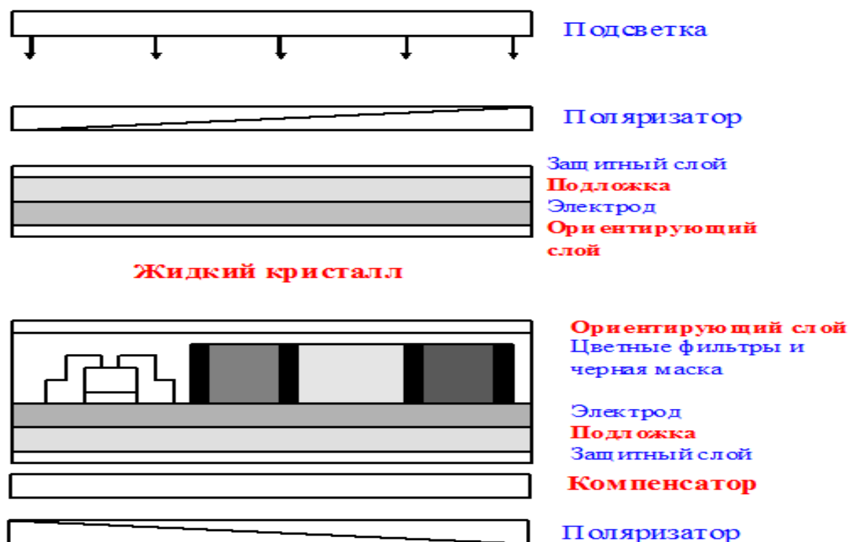
Рис.1.5. Исследуемые составляющие (красный цвет) жидкокристаллических индикаторных средств (дисплеев).
