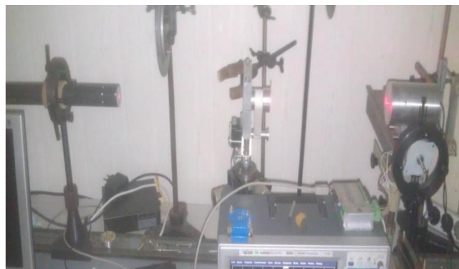
Рис.2.6. Общий вид установки. Также можно запрограммировать движение двигателя с заданным ускорением и движением назад.
