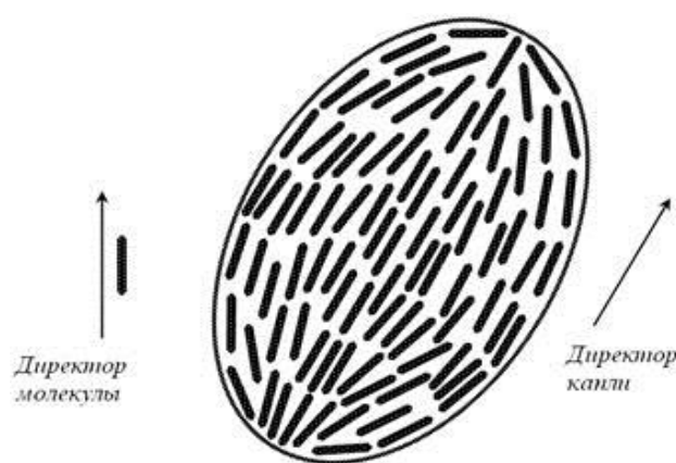
Рис.1.3. Директор капли результирующий, с ним строго совпадает направление лишь некоторой части молекул [8]
