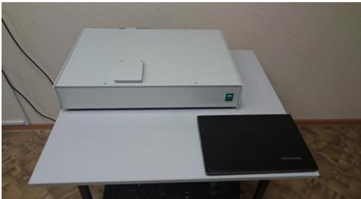
Рисунок 2 – Экспериментальный образец анализатора геометрических параметров наночастиц и дзета-потенциала
