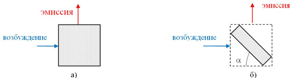
Рисунок 5 – Сравнение геометрии мер флуоресценции
